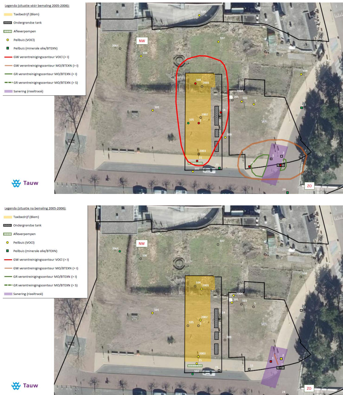
Figuur 3.1 Tekening voor (boven) en na (onder) bemalingswerkzaamheden (2005-2006) met daarin aangegeven de verontreinigingscontouren en de richting van de dwarsdoorsnede die is gebruikt in het conceptuele model.
