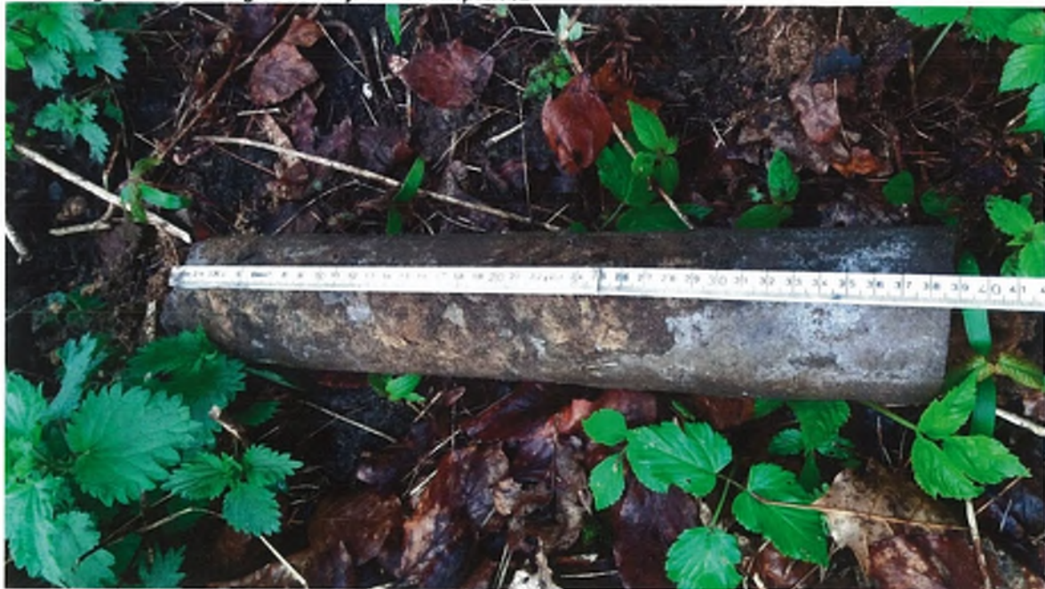
Afbeelding 3: AC-buis aangetroffen bij onderzoekspunt 02
