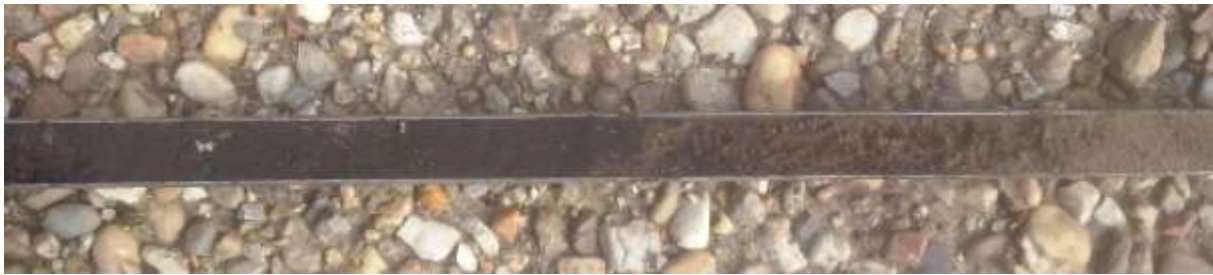
Figuur 14: Foto van boring 1 met links moerig zand en rechts de C-horizont. Hiertussen is een enkele brok veen herkenbaar.
