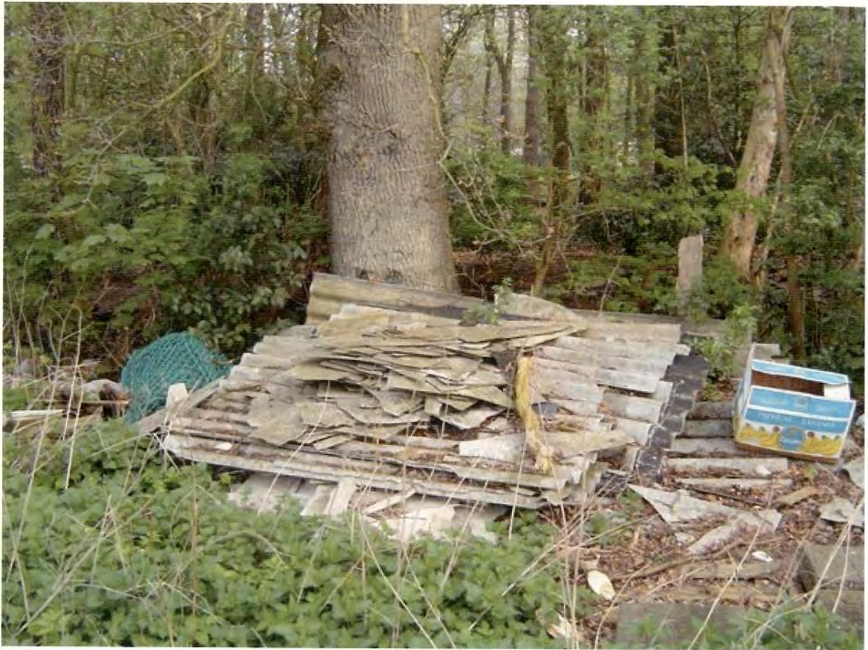
Foto: Asbest platen/stukken aan de noordzijde van bouwblok 8.
