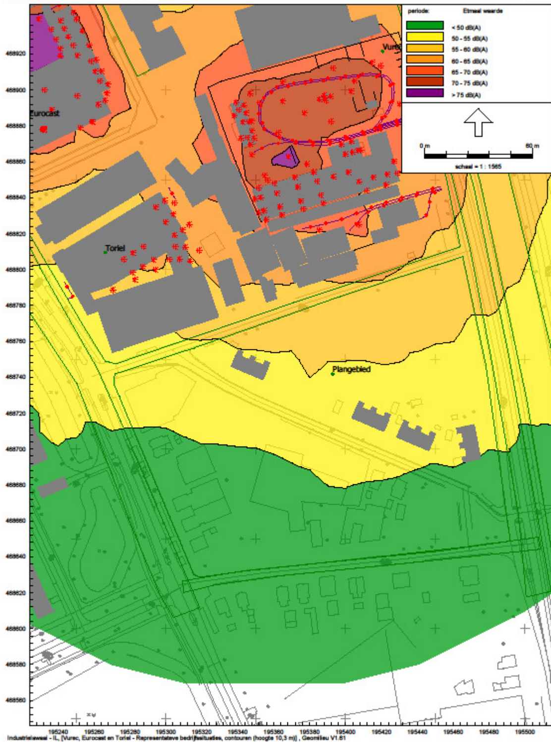
Representatieve bedrijfssituatie Vurec, Eurocast en Toriel (vergund) cumulatieve etmalelwaarde contouren (hoogte 10.3 m boven het maaiveld)
