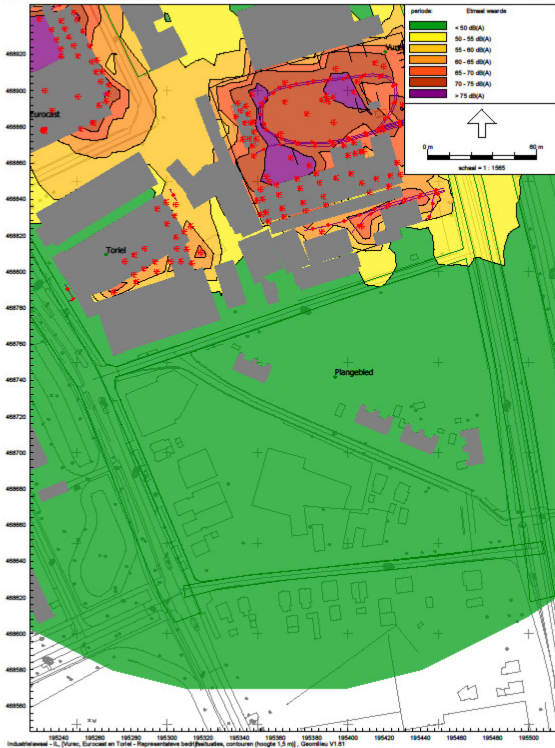
Representatieve bedrijfssituatie Vurec, Eurocast en Toriel (vergund) cumulatieve etmaalwaardecontouren (hoogte 1,5 m boven het maaiveld)
