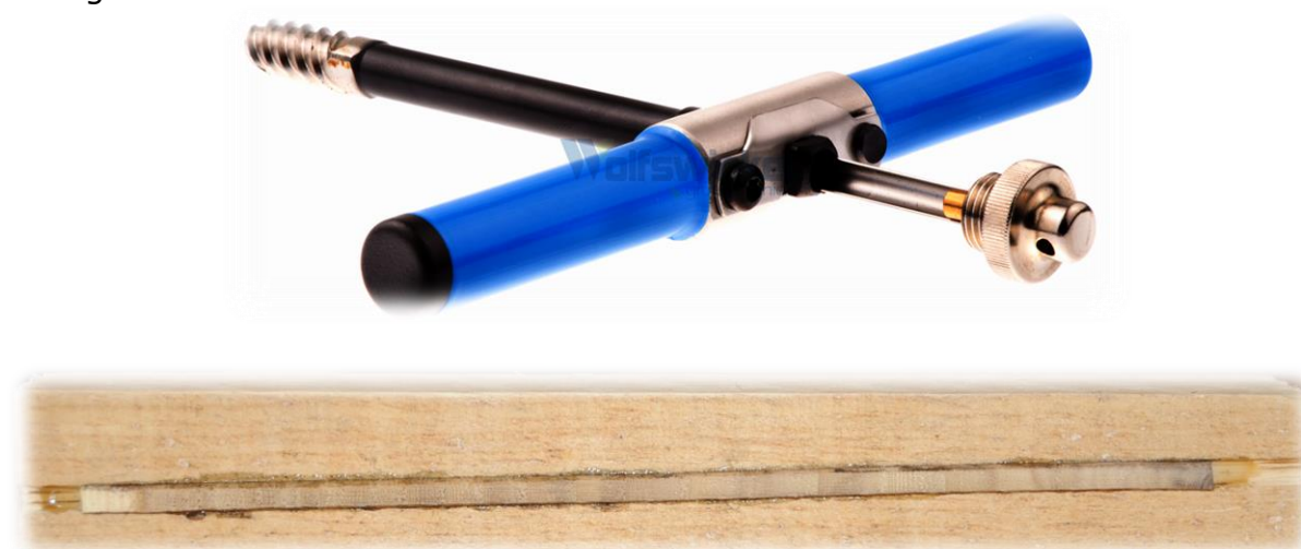
Houtaanwasboor (boven) en geprepareerd houtaanwasmonster (onder) t.b.v. jaarringanalyse
