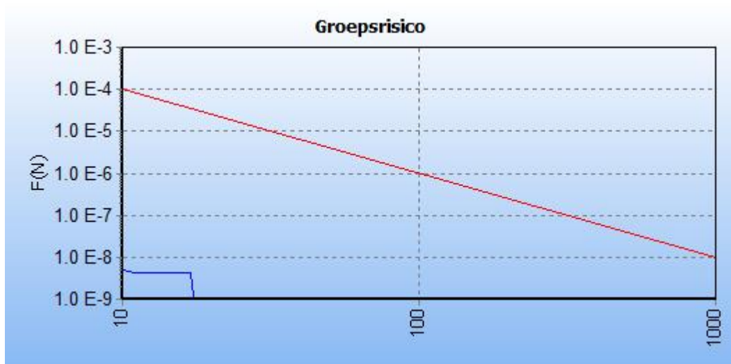
5.5 Figuur 5.5 FN curve voor 1045_leiding-N-567-20-deel-1_incl verl van N.V. Nederlandse Gasunie voor de kilometer tussen stationing 4070.00 en stationing 5070.00
