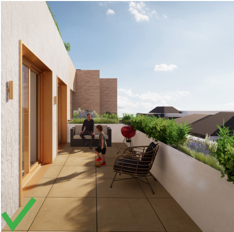
De plantenbak is meeontworpen met de balustrade. De bakken hebben voldoende diepte- en breedtemaat voor goede groei van beplanting.
