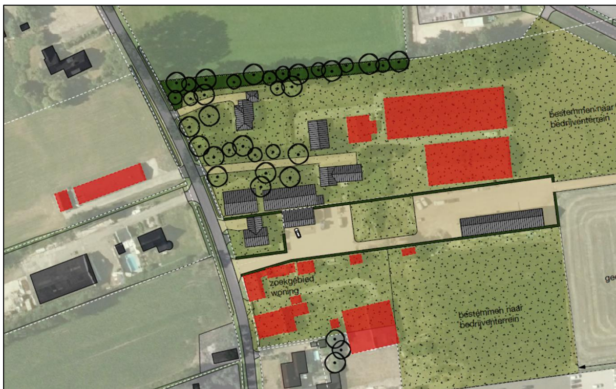
Afbeelding 2.1 Slopen bebouwing (Bron: De Erfontwikkelaar)
