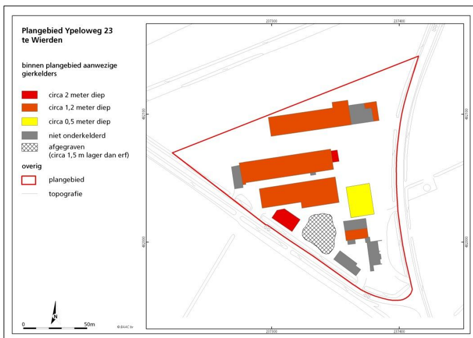
Figuur 2.7 Overzicht van de onderkeldering ter plaatse van het plangebied.
