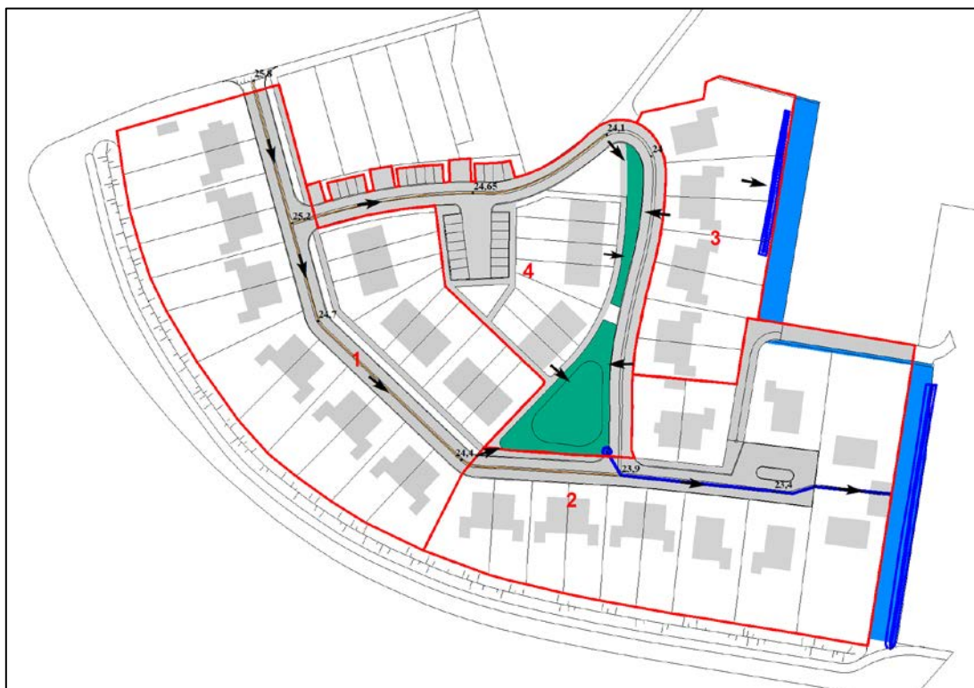
Figuur 22 Ligging van de bestaande greppels (donkerblauw) en de gereserveerde ruimte voor de zaksloten (lichtblauw)
