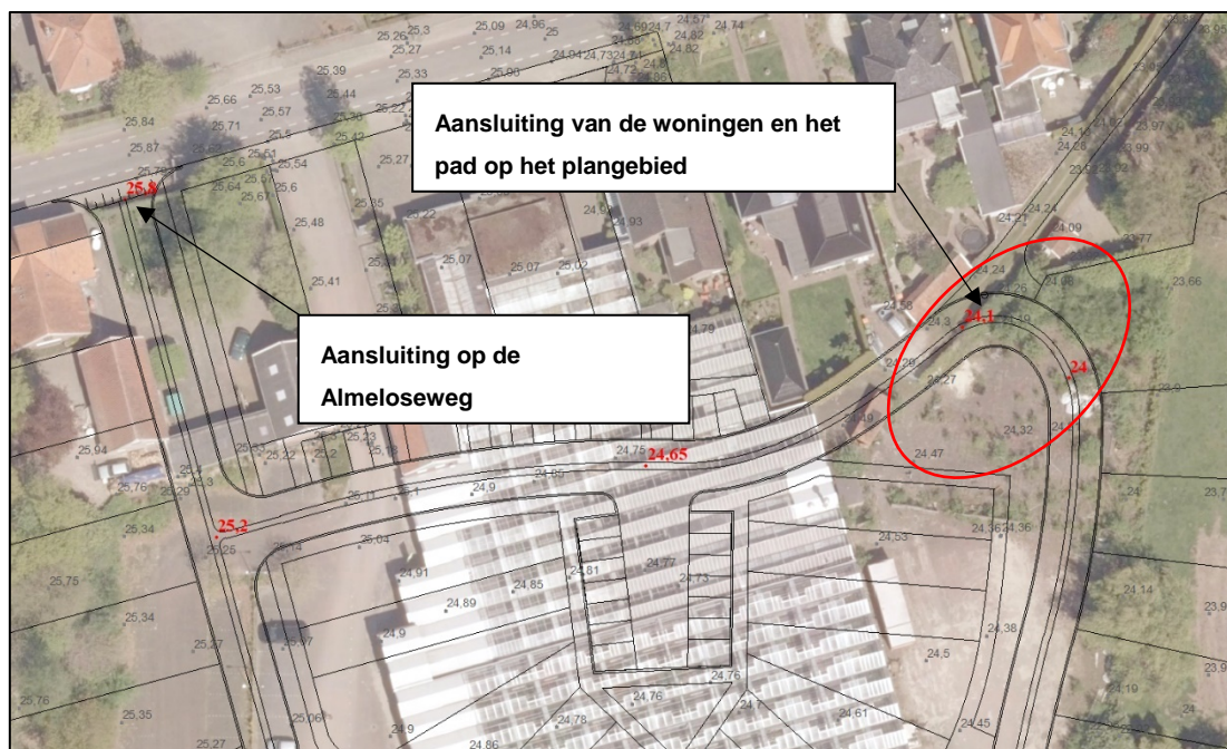
Figuur 17 Aansluiting op de omgeving. Met rood de ontwerp straathoogten en in het grijs de bestaande hoogten
