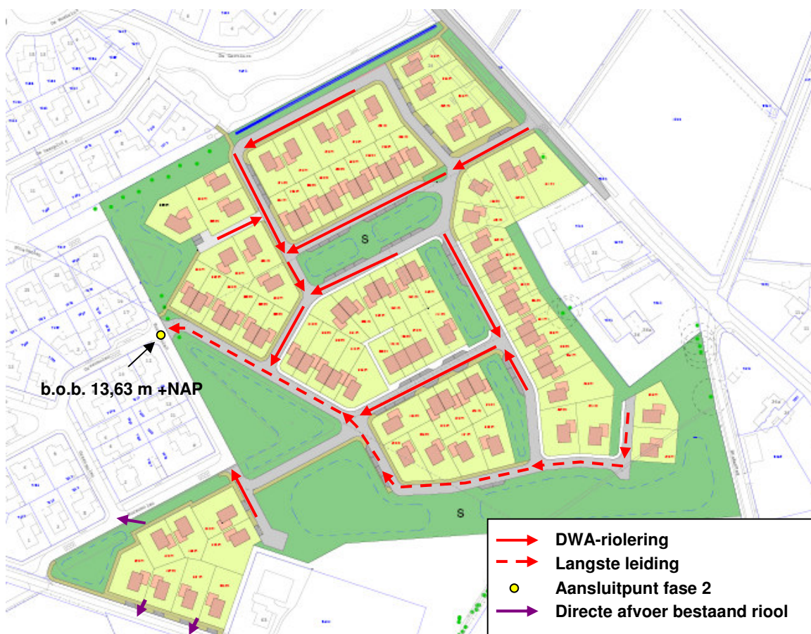
Figuur 4.3: structuur en afvoerrichting afvalwatersysteem
