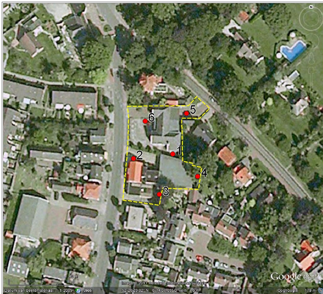
Figuur 5: Heino, Dorpsstraat 44-46: boorpuntenkaart. Het onderzoeksgebied is aangegeven door een onderbroken gele lijn. De genummerde punten geven de ligging weer van de zes boringen.
