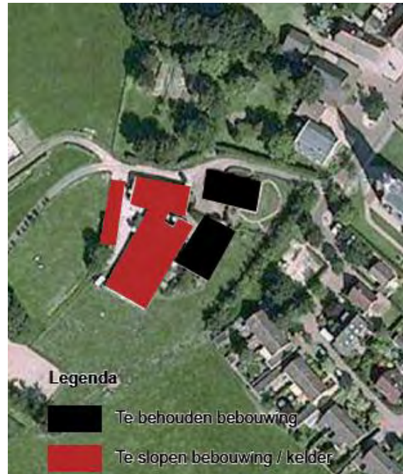
Figuur 1: Huidige situatie planlocatie Kerkslagen met de te slopen bebouwing en kelder
