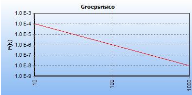
5.10 Figuur 5.10 FN curve voor 6165_leiding-A-509-09-deel-1 van N.V. Nederlandse Gasunie voor de kilometer tussen stationing 0.00 en stationing 90.00
