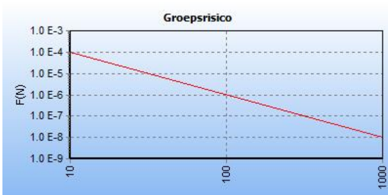
5.23 Figuur 5.23 FN curve voor 6165_leiding-A-588-deel-1 van N.V. Nederlandse Gasunie voor de kilometer tussen stationing 0.00 en stationing 1000.00
