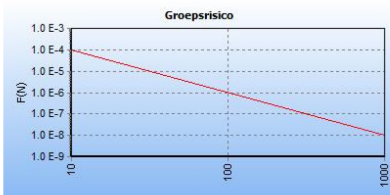
5.16 Figuur 5.16 FN curve voor 6165_leiding-A-516-deel-1 van N.V. Nederlandse Gasunie voor de kilometer tussen stationing 650.00 en stationing 1650.00
