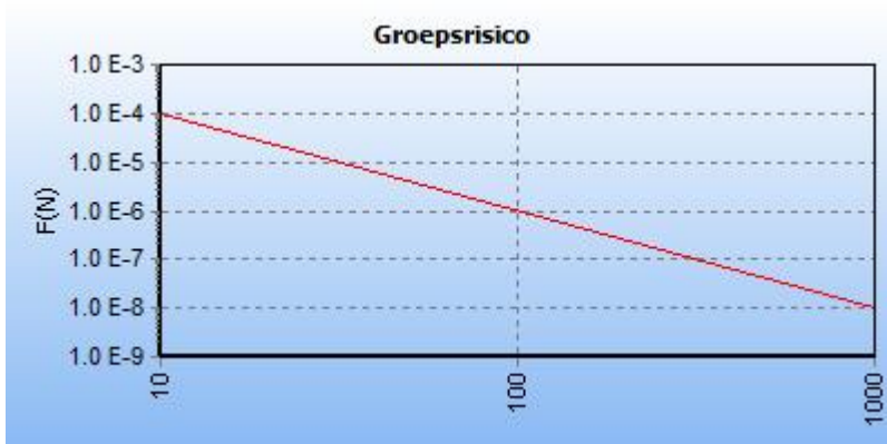
5.19 Figuur 5.19 FN curve voor 6165_leiding-A-522-deel-1 van N.V. Nederlandse Gasunie voor de kilometer tussen stationing 0.00 en stationing 1000.00
