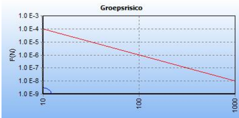
5.30 Figuur 5.30 FN curve voor 6165_leiding-A-662-deel-1 van N.V. Nederlandse Gasunie voor de kilometer tussen stationing 80.00 en stationing 1080.00
