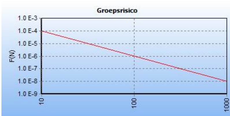
5.11 Figuur 5.11 FN curve voor 6165_leiding-A-509-deel-1 van N.V. Nederlandse Gasunie voor de kilometer tussen stationing 650.00 en stationing 1650.00
