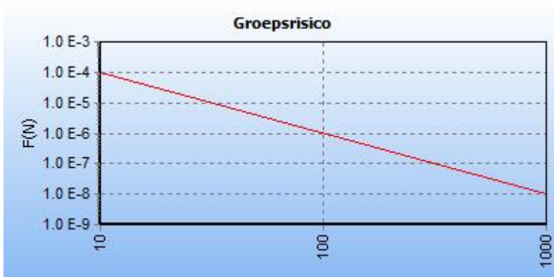
5.23 Figuur 5.23 FN curve voor 6165_leiding-A-588-deel-1 van N.V. Nederlandse Gasunie voor de kilometer tussen stationing 0.00 en stationing 1000.00
