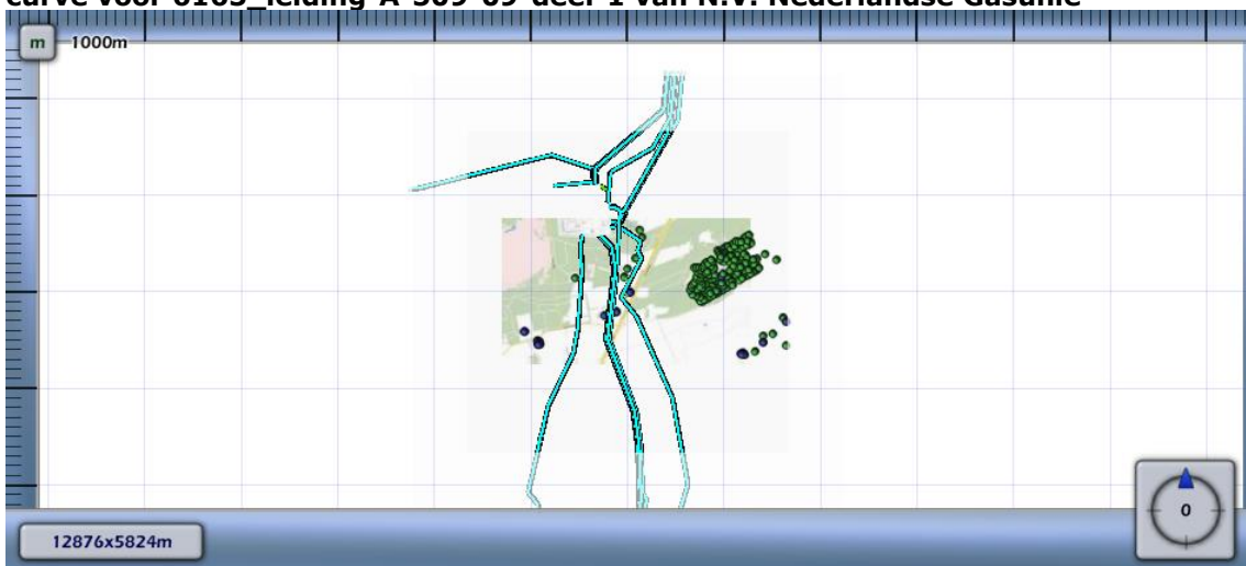
Figuur 4.10 Kilometer leiding behorende bij de maximale overschrijding van de FN-curve voor 6165_leiding-A-509-09-deel-1 van N.V. Nederlandse Gasunie
