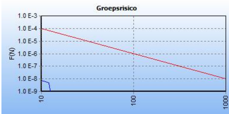
5.22 Figuur 5.22 FN curve voor 6165_leiding-A-549-deel-1 van N.V. Nederlandse Gasunie voor de kilometer tussen stationing 0.00 en stationing 1000.00
