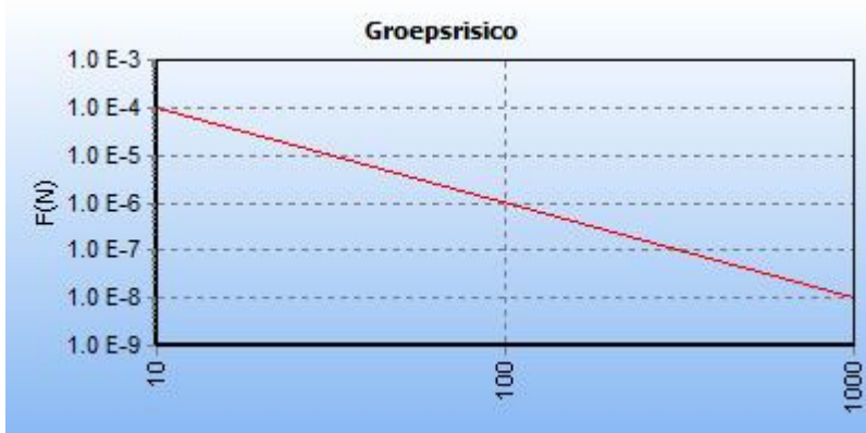
5.4 Figuur 5.4 FN curve voor 6165_leiding-A-503-deel-1 van N.V. Nederlandse Gasunie voor de kilometer tussen stationing 650.00 en stationing 1650.00
