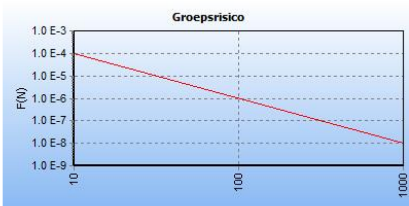
5.5 Figuur 5.5 FN curve voor 6165_leiding-A-505-deel-1 van N.V. Nederlandse Gasunie voor de kilometer tussen stationing 0.00 en stationing 1000.00
