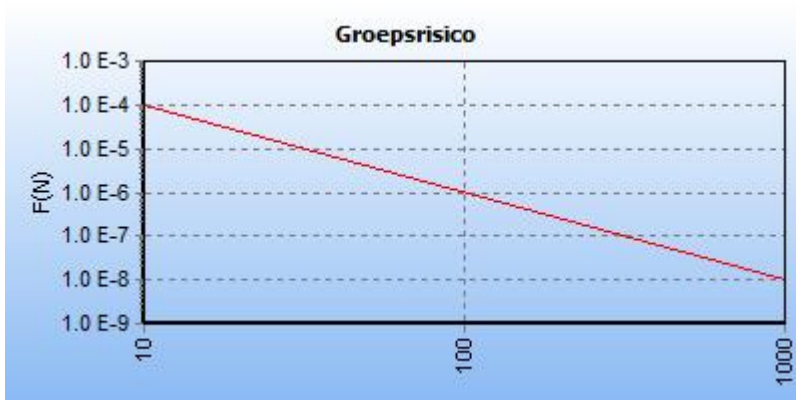
5.29 Figuur 5.29 FN curve voor 6165_leiding-A-661-deel-1 van N.V. Nederlandse Gasunie voor de kilometer tussen stationing 630.00 en stationing 1630.00
