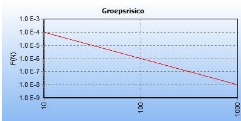
5.17 Figuur 5.17 FN curve voor 6165_leiding-A-519-05-deel-1 van N.V. Nederlandse Gasunie voor de kilometer tussen stationing 0.00 en stationing 180.00
