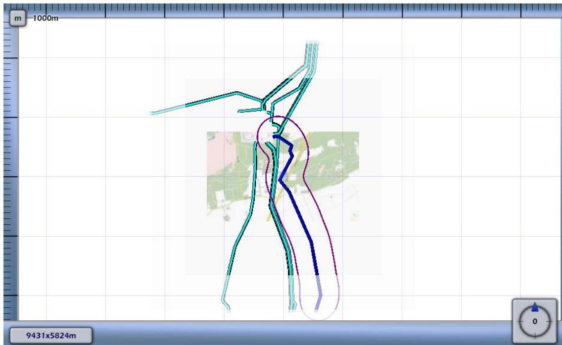
3.21 Figuur 3.21 Plaatsgebonden risico voor 6165_leiding-A-529-deel-1 van N.V. Nederlandse Gasunie
