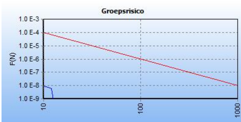
5.20 Figuur 5.20 FN curve voor 6165_leiding-A-523-deel-1 van N.V. Nederlandse Gasunie voor de kilometer tussen stationing 190.00 en stationing 1190.00
