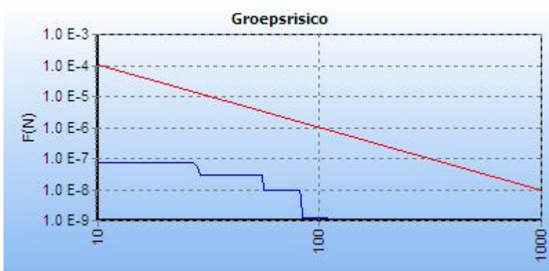
Figuur 5.2 fN curve voor N-528-21 van N.V. Nederlandse Gasunie voor de kilometer tussen stationing 8170.00 en stationing 9170.00
