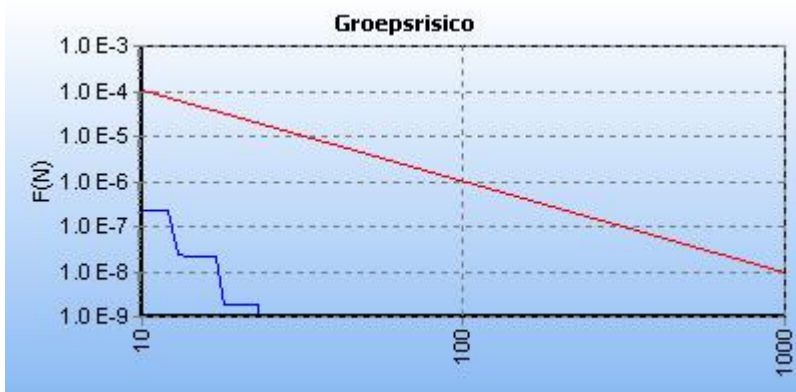
Figuur 5.1 FN curve voor N-528-80 van N.V. Nederlandse Gasunie voor de kilometer tussen stationing 980.00 en stationing 1980.00.
