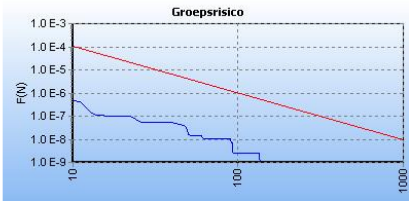
Figuur 5.2 FN curve voor N-528-21 van N.V. Nederlandse Gasunie voor de kilometer tussen stationing 5600.00 en stationing 6600.00
