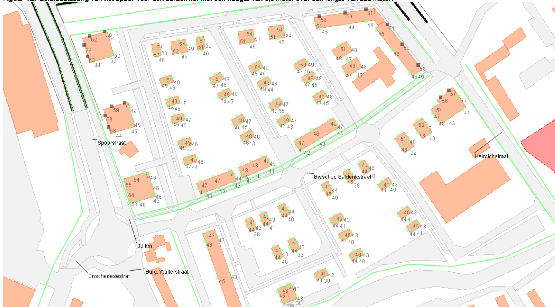
Figuur 4.2: Geluidbelasting van het spoor voor een aardenwal met een hoogte van 6,5 meter over een lengte van 232 meter.
