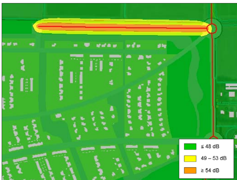
Figuur 4.3: Geluidscontour van de Rondweg (waarneemhoogte 4,5 m, representatief voor de eerste verdieping, inclusief correctie conform artikel 110g)
