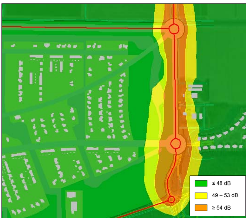
Figuur 4.1: Geluidscontour van de Banterweg (waarneemhoogte 4,5 m, representatief voor de eerste verdieping, inclusief correctie conform artikel 110g)
