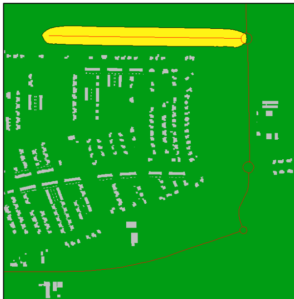
Figuur 4.2: Geluidscontour van de noordelijke randweg (in het groen gekleurd gebied bedraagt de geluidsbelasting maximaal 48 dB; in het geel gekleurd gebied ligt de waarde hoger)
