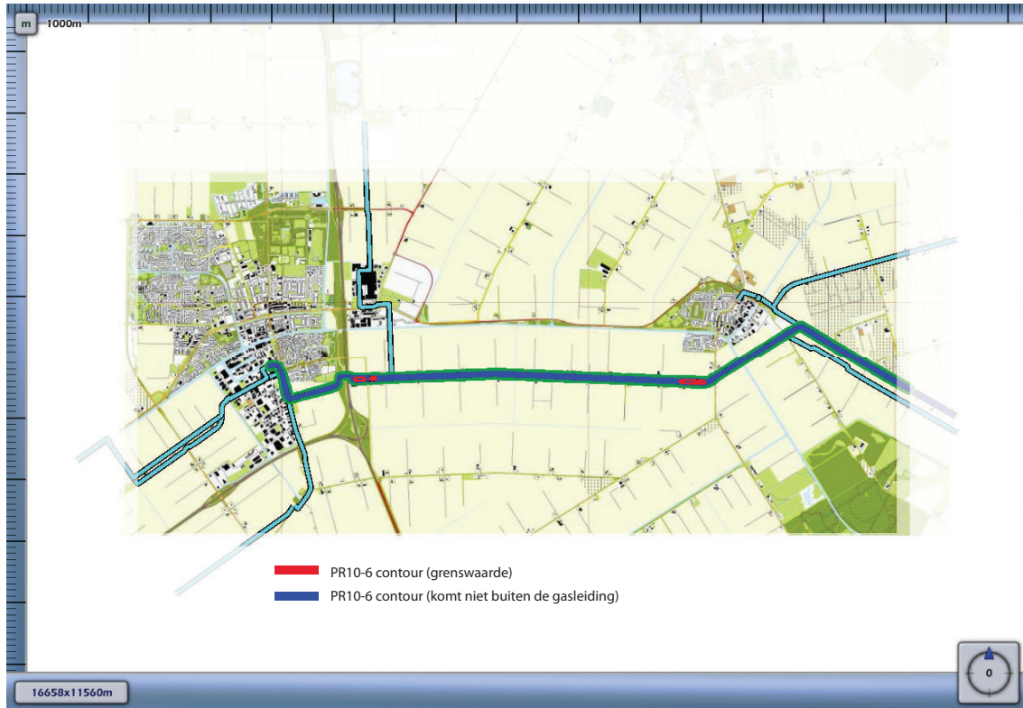
Figuur 4-2: Plaatsgebonden risico van de N-500-50 van N.V. Nederlandse Gasunie
