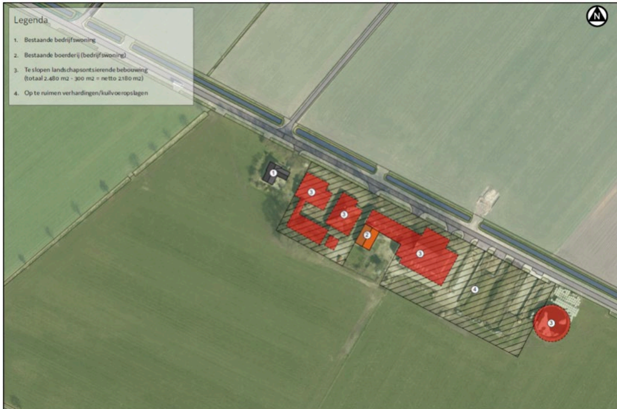
Afbeelding 3.2 Te slopen bebouwing (Bron: De Erfontwikkelaar)
