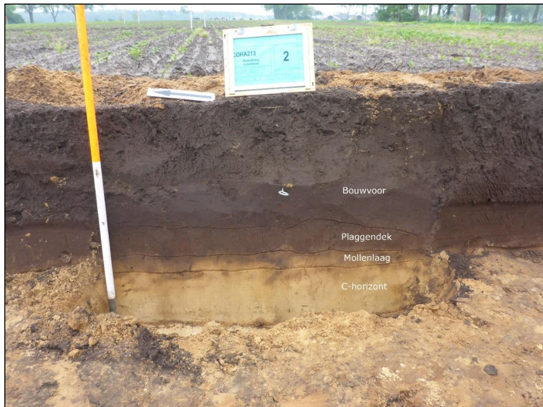
Afbeelding 4. Representatieve bodemopbouw van het zuidelijke deel van het plangebied, zoals weergegeven in profiel 101.
