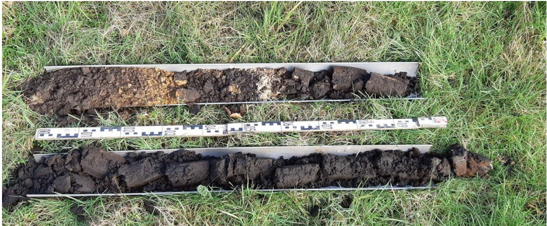
Afbeelding 13: Foto van het bodemprofiel van boring 6 met onder de gevlekte ophoging de donkere humeuze slijbbige slootvulling met daaronder een B- en C-horizont 21 . Lengte gootje = 1 meter.
