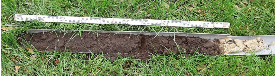
Afbeelding 12: Foto van het bodemprofiel van boring 5 in deelgebied 1. Lengte gootje = 1 meter. V.l.n.r. de grijsbruine bouwvoor, de bruine eerdlaag en het grijze dekzand.
