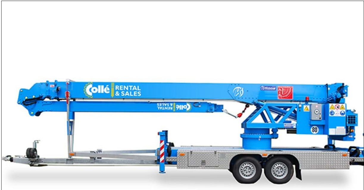
Voorbeeld van een lichte, mobiele kraan. Geschikt voor aanreiken van dakpannen, dakleer en gordingen.
