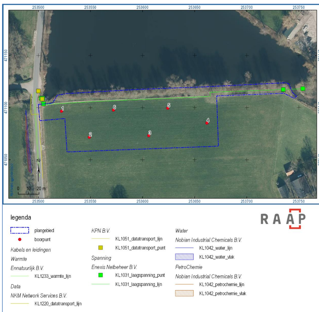
Figuur 10. Het plangebied met de geplaatste boorpunten, inclusief locatie bekende kabels en leidingen (KLIC)
