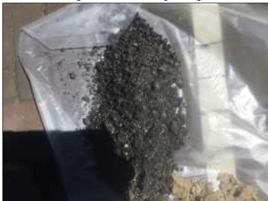
Foto 17: Kolengruishoudende laag boring 10
