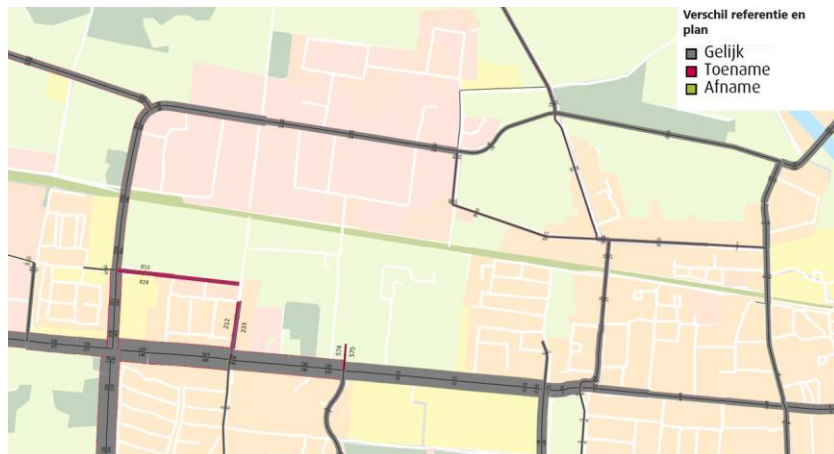
Figuur 6: Het effect van de plannen voor Eschmarkerveld op het omliggend wegennet (verschil in weekdagintensiteiten in motorvoertuigen per etmaal tussen het referentiescenario 2034 en het planscenario 2034)
