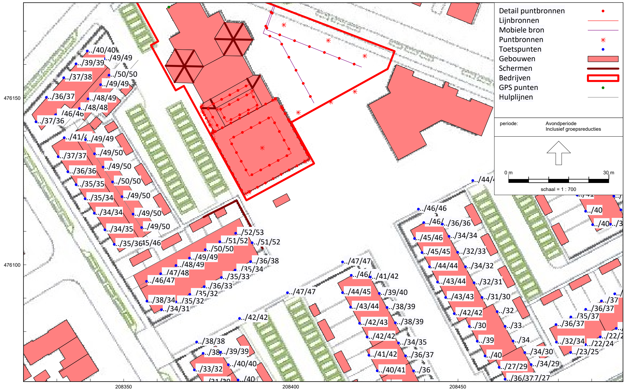
Figuur 14 Langtijdgemiddeld beoordelingsniveau voor eerste verdieping / tweede verdieping avondperiode met geluidsscherm 1,8 meter hoog 2 woningen
