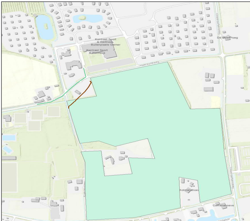
Figuur 5-8 Ligging 50 dB(A) etmaalwaarde contour indirecte hinder op een hoogte van 5 meter
