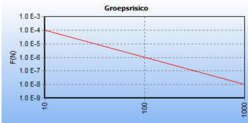
5.13 Figuur 5.13 FN curve voor 8393_leiding-A-648-deel-1 van N.V. Nederlandse Gasunie voor de kilometer tussen stationing 630.00 en stationing 1630.00
