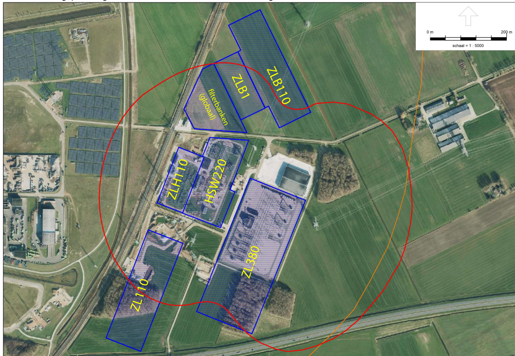
f2.4 Overzicht hoogspanningsstation inclusief voorziene uitbreidingen
