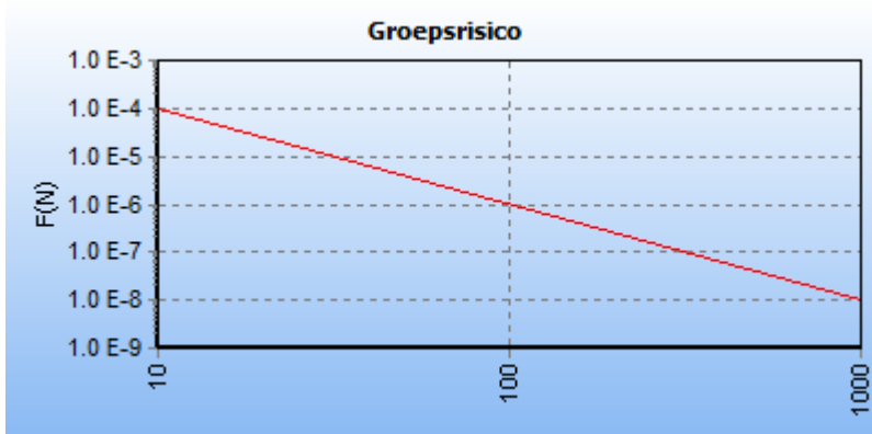
5.13 Figuur 5.13 FN curve voor 293_leiding-N-531-33-deel-1 van N.V. Nederlandse Gasunie voor de kilometer tussen stationing 740.00 en stationing 1740.00
