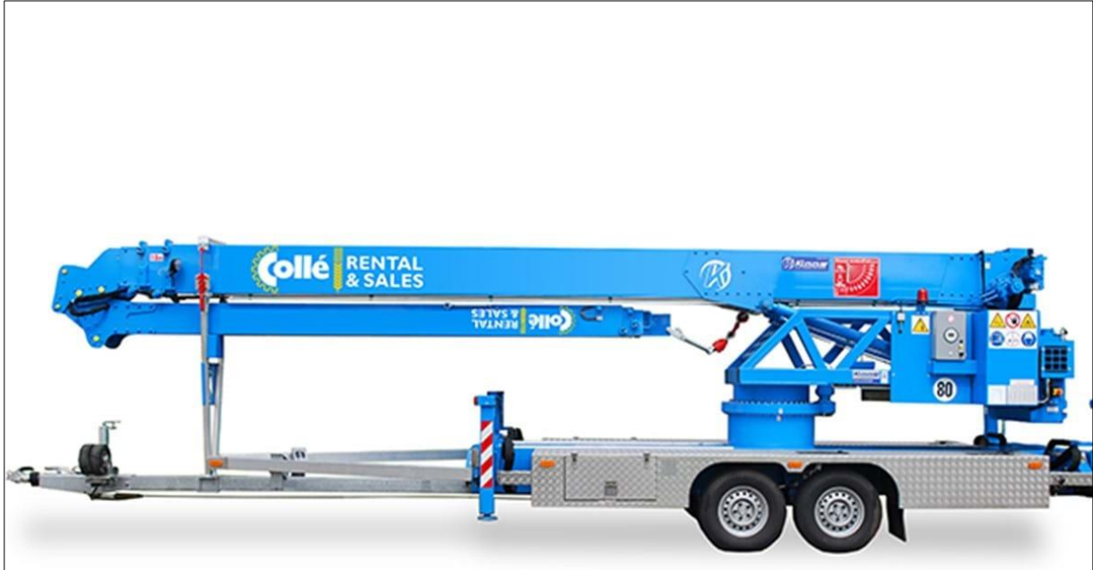
Voorbeeld van een lichte, mobiele kraan. Geschikt voor aanreiken van dakpannen en isolatiemateriaal.
