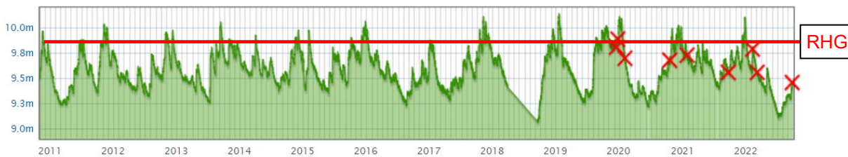
Afbeelding 4 Gemeten grondwaterstanden in monitoringspeilbuis Pb15.03 (bron [5])
