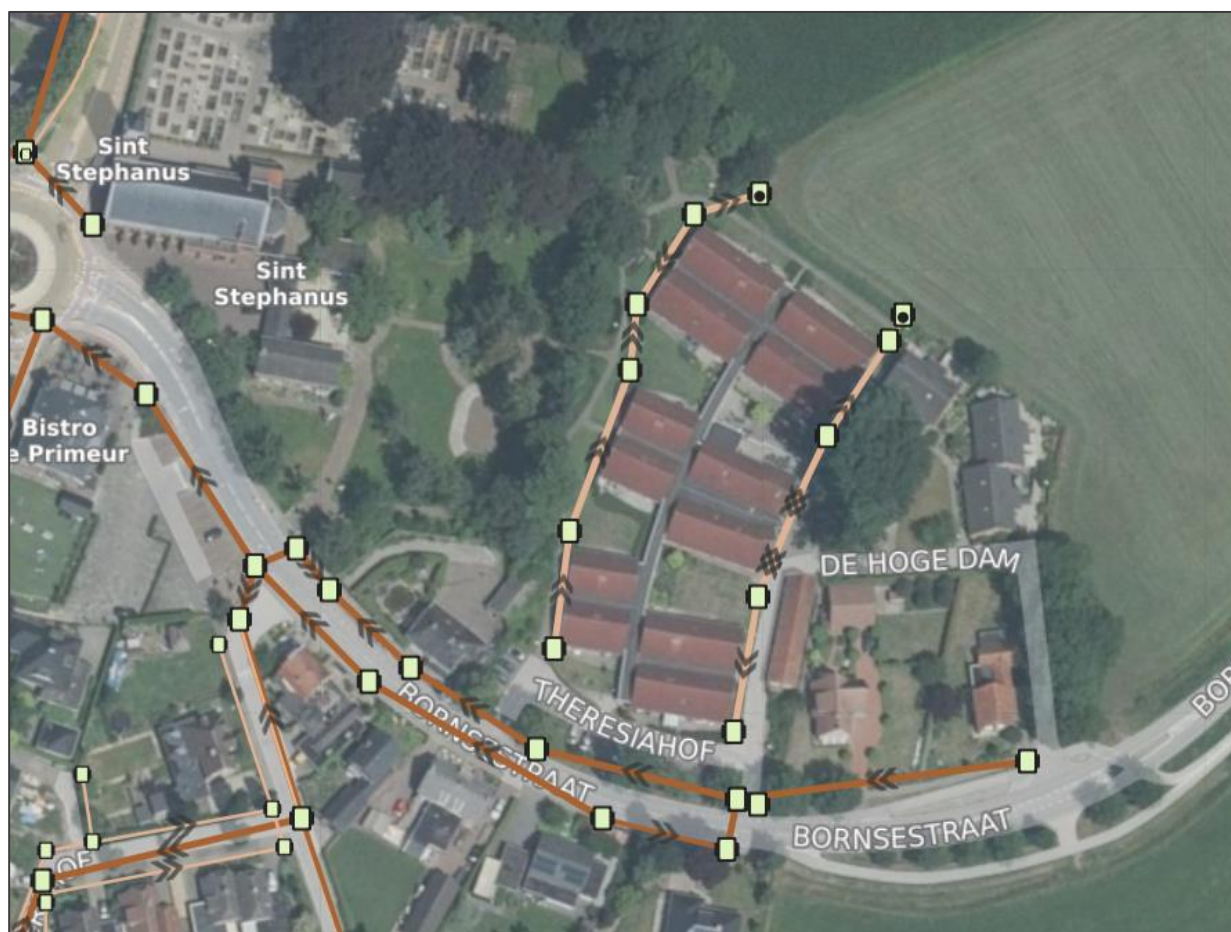
Afbeelding 5: Riolering bestaande situatie
