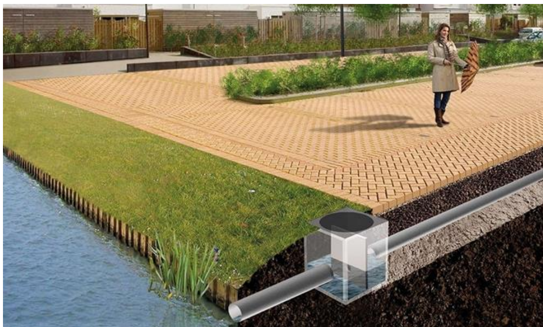
Figuur 5.4: schematisch overzicht waterbergende wegen met ondergrondse infiltratie/drainage (boven) en visualisatie (onder).
