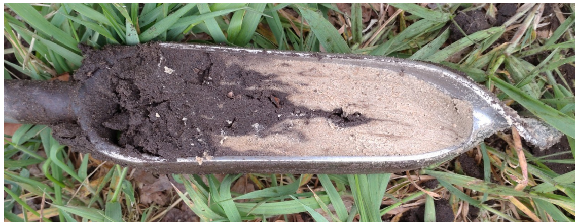
Figuur 8: De Schiphorst, Schiphorsterweg 25: Boring 4: 110-130 centimeter onder maaiveld. De scherpe overgang van de vergraven bodem naar de C-horizont.
