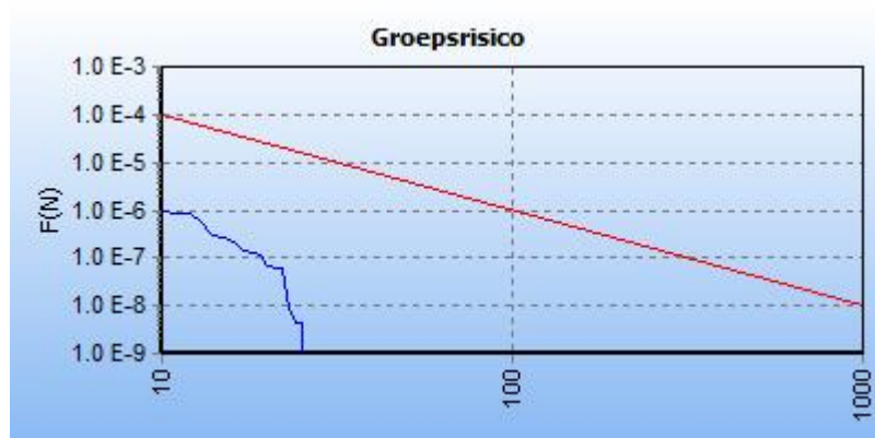
Figuur 5.1 FN curve voor 8890_leiding-N-520-15-deel-1 van N.V. Nederlandse Gasunie voor de kilometer tussen stationing 2290.00 en stationing 3290.00
