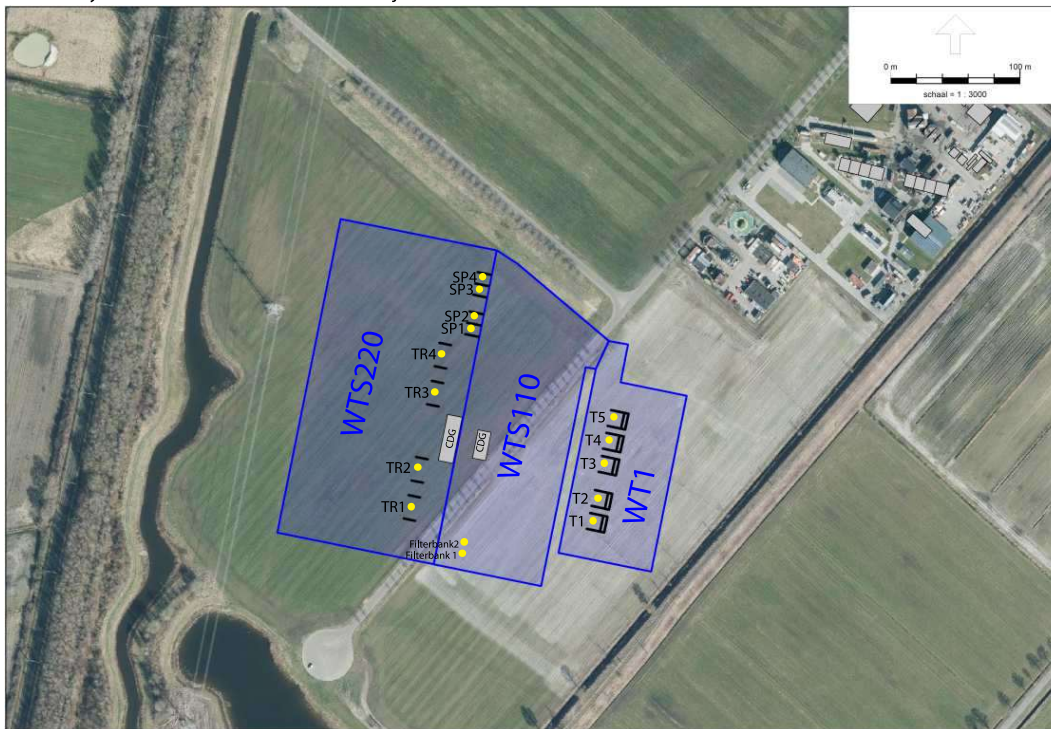
f2.2 Globale lay-out van transformatorstation Wijster
