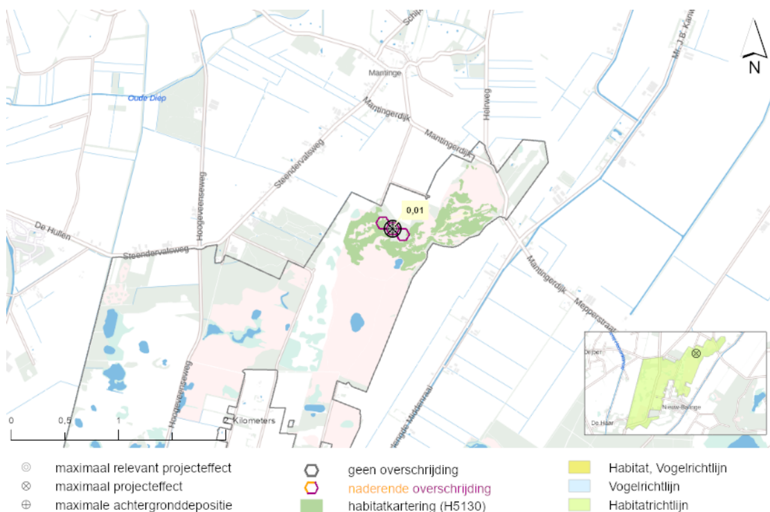
Figuur 6.7 De locatie in het Natura 2000-gebied Mantingerzand met de maximale relevante toename aan stikstofdepositie op Jeneverbesstruwelen (H5130).
