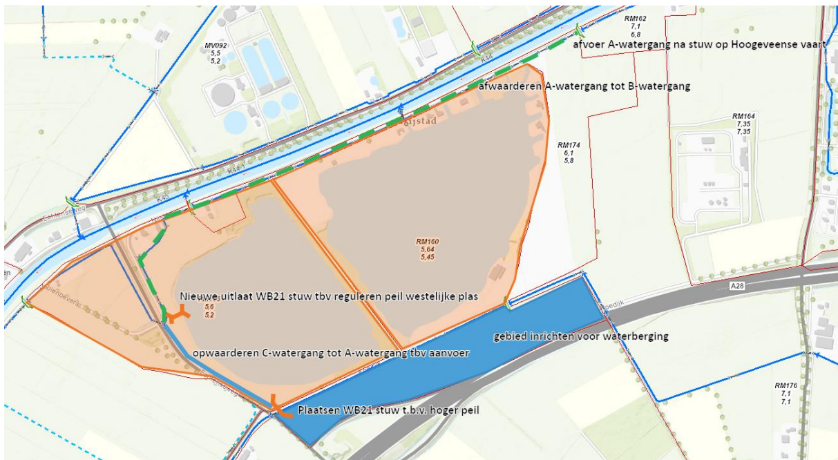
Kaartbeeld principeoplossingen voor nieuwe watersysteem op basis van 3 peilvakken (zandwinplas-west, zandwinplas-oost, gebied Koedijk-snelweg).
