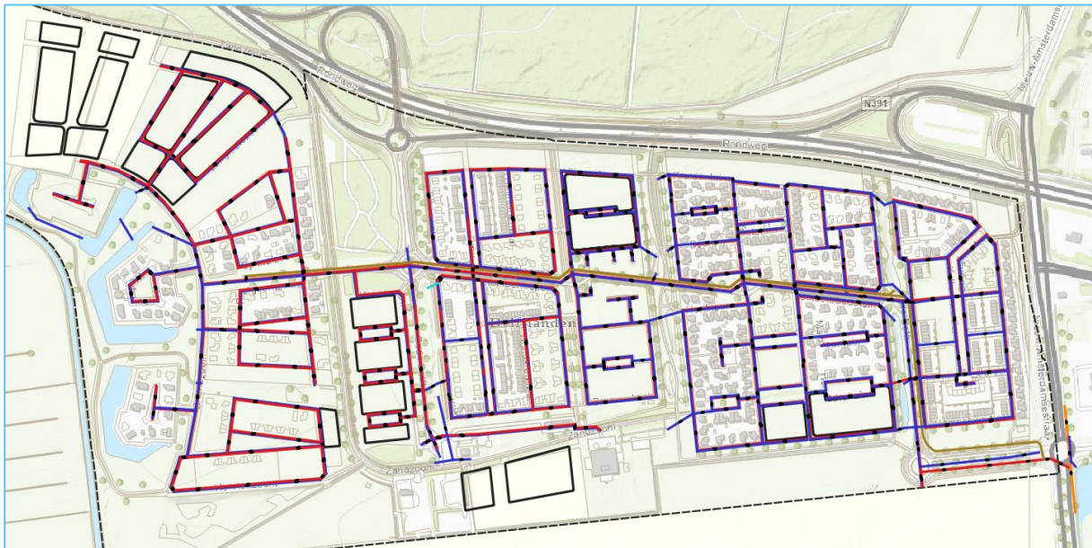
Figuur 4-6: De huidige ligging en het type rioolleiding in het plangebied en de aansluiting op de omgeving aan de oostzijde.
