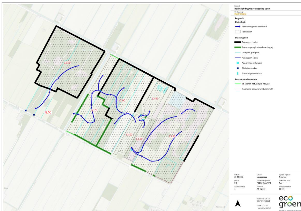
Figuur 2.2: Hydrologische maatregelen herinrichting Oosteindsche Veen (zie bijlage A.1 voor een grote versie)
