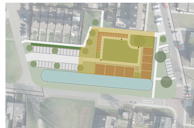
Maaiveld onder het gele vlak dient verhoogd te worden en aan te sluiten op het maaiveld ten noorden van het plangebied.
