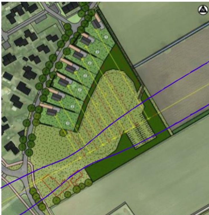
Afbeelding 4.1 Het bestemmingsplan en de 3 [A/m] magneetveldgrens (Blauw)
