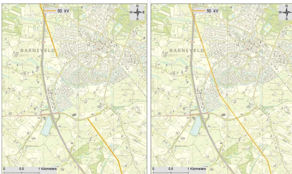
Figuur 12 De 50 kV-lijn die in de oude Netkaart nog door de bebouwde kom van Barneveld loopt (rechter plaatje) is ondergronds gebracht, zoals de nieuwe Netkaart (linker plaatje) weergeeft.
