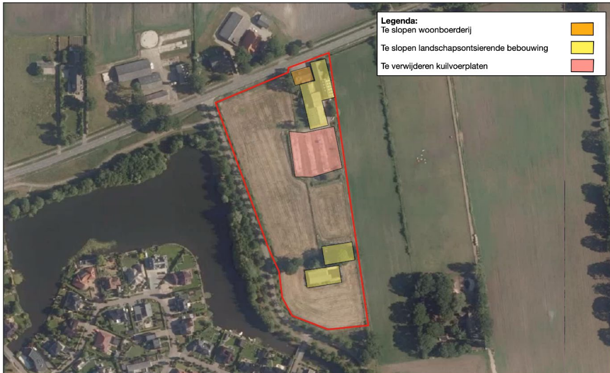
Afbeelding 2.1 Te slopen bebouwing in het projectgebied
