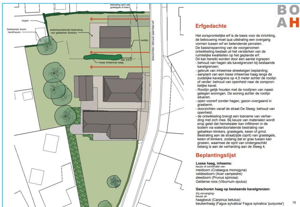
Figuur 2.9 : Weergave gewenste erfinrichting afkomstig uit BKP naast De Steeg 4 te Dalen
